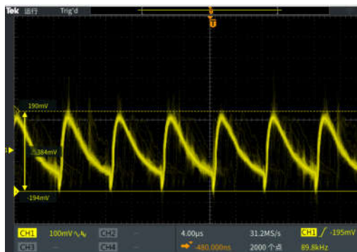
图四不推荐测试方法为 \Delta V_{pp}=384\text{mV}
